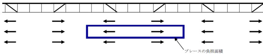
・スラブ側の吊ボルトに設置したブレースが2本以上重ならないようにする。重なる場合はブレースの位置をずらす。
