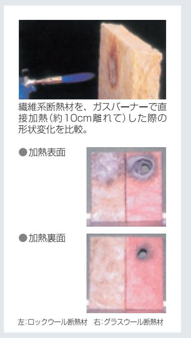
熱伝導率=熱の伝わる度合いを表したもので。数値が小さいほど熱を伝えにくく、ロックウールはグラスウール(10kg/m³)よりも断熱性に優れていることを示しています。断熱基準がさらに厳しくなる中、コストと厚さを抑えて、快適な住環境を確保します。
