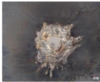
写真1 A破壊 (ピン部分の材料破壊)
