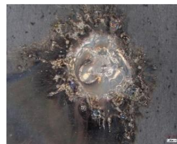
写真3 ab破壊 (空隙のある溶接面凝集破壊)
