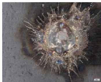
写真2 a破壊 (溶接面凝集破壊)
