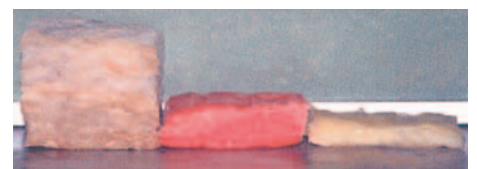
ロックウール 断熱材 グラスウール 16K 細繊維 グラスウール 10K
